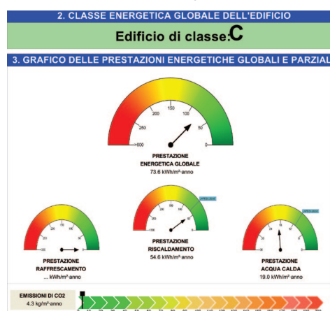
Dopo lo STEP 01 (installazione cappotto isolante) l'edificio passa da classe F a classe C
